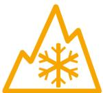
Reifen, die das „Bergpiktogramm mit Schneeflocke“ aufweisen, bieten hinsichtlich Sicherheit und Kontrolle bei winterlichen Verhältnissen eine nachgewiesene Eignung. Die „Three-Peak Mountain Snowflake“ (3PMSF) Kennzeichnung erhalten Reifen, die einen Praxistest auf schneebedeckter Fahrbahn bestehen und eine um mindestens 25 Prozent bessere Traktion bieten als die Referenzreifen.\*
