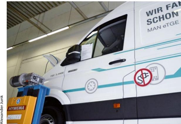
Roter Aufkleber und Zettel am Fenster warnen, wenn am Hochvolt-system Wartungs- und Reparaturarbeiten durchgeführt werden
