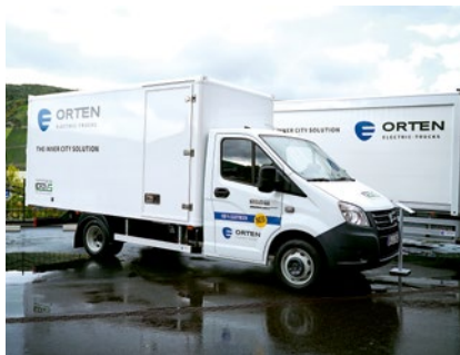
Neuer Mitbewerber im KEP-Markt: Orten ET 35 EF mit 110 kW und 650 Nm Drehmoment
