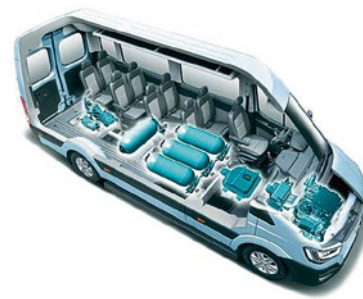
Fuel in der Flasche: So könnte 2020 der Antrieb des H350 Fuel Cell Concept angeordnet sein
